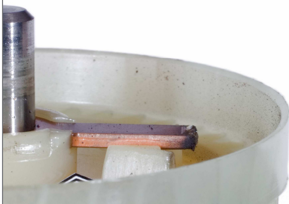
Cliché 8 : Détail du charbonnage sur le doigt de la distribution de la magnéto gauche
