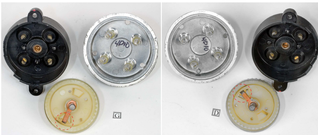
Cliché 6 : Traces de charbonnage sur la distribution de la magnéto gauche
