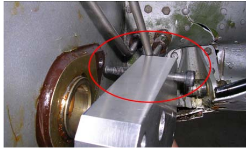
Essai de montage du guide avec les conduites hydrauliques de freinage en secours connectées
