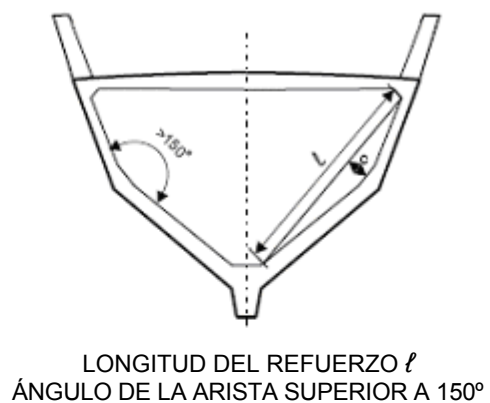
BULÁRCAMAS TRANSVERSALES Y PALMEJARES LONGITUDINALES
