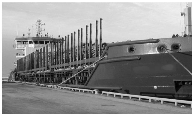
Figura 6.9: Pies derechos que bloquean la totalidad de la altura de la estiba
