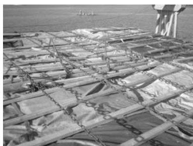
Trincas de cadena
