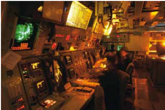
CIC DE LA FRAGATA "WILLIAMS" – CENTRO DESDE DONDE SE DIRIGE LAS OPERACIONES DE UNA FUERZA Y DE LA PROPIA UNIDAD DE COMBATE
